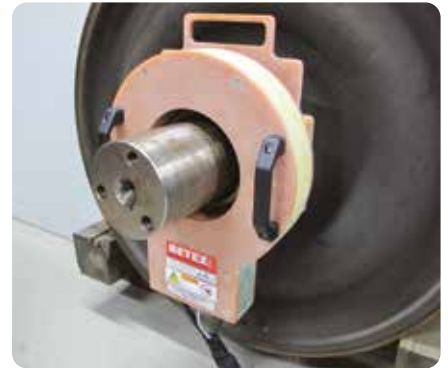
Erwärmung eines Labyrinthrings zur Demontage
