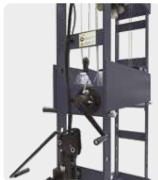
Mit Hilfe des Kettenzugs höhenverstellbarer Kettenzug
