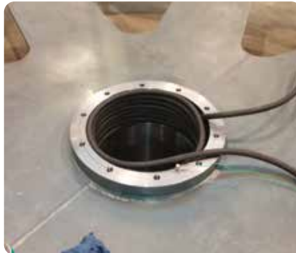
Erwärmung einer Bohrung zur Montage von Lager oder Achse
