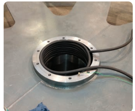
Erwärmung einer Bohrung zur Montage von Lager oder Achse
