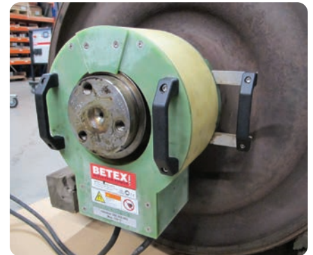
Erwärmung eines Lagerrings zur Demontage
