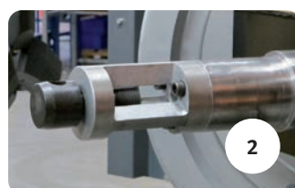
Montage von TBU / SP / Tarol-Lagersätzen in Einzelschritten
