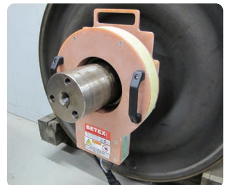
Erwärmung eines Labyrinthrings zur Demontage
